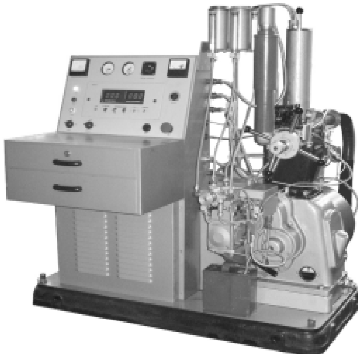
Рисунок 1 — Установка ИДТ-90 для определения цетанового числа
